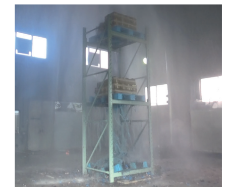
Test extinguishing of a lithium-ion storage battery using a sprinkler system スプリンクラー設備によるリチウムイオン蓄電池の消火実験
